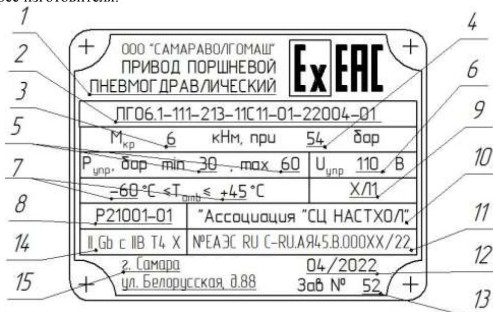
Рисунок 1 – Фирменная табличка привода (пример маркировки).
